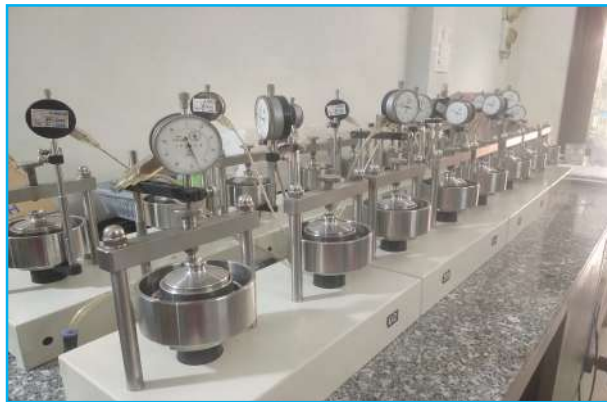
Thí nghiệm đặc biệt: Nén cố kết (Cv)
