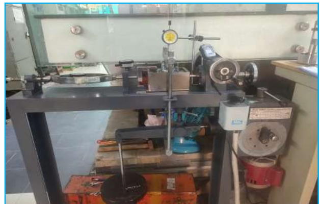
Thí nghiệm đặc biệt: Cắt phẳng D3080
